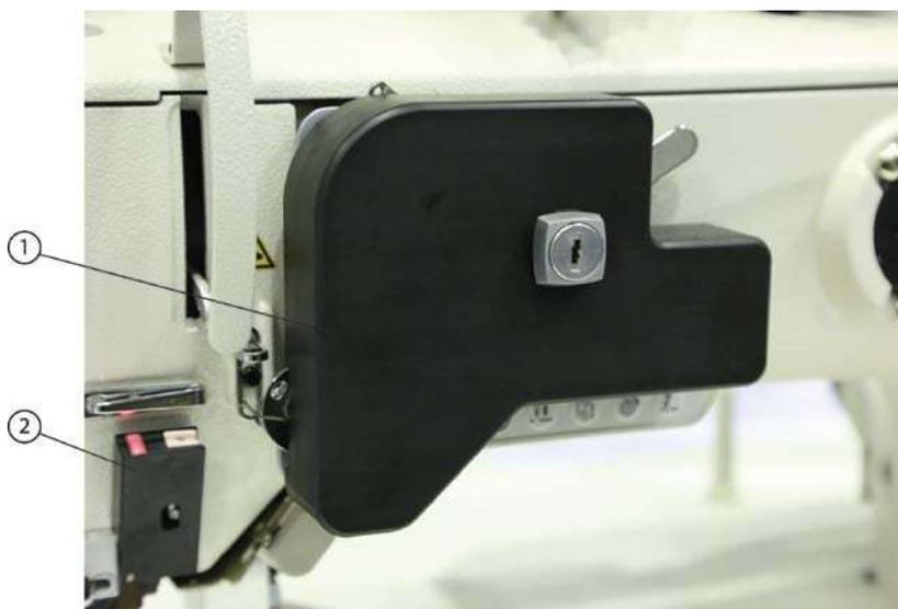
1 – regulador de tensão de linha superior    2 – monitor de tensão de linha superior
