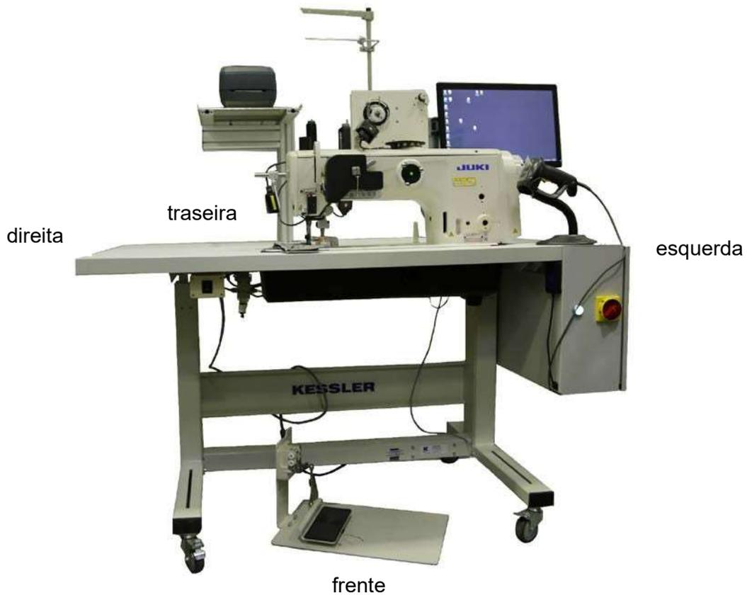
Fig. 2. A máquina de costura industrial SADE – lados da máquina
