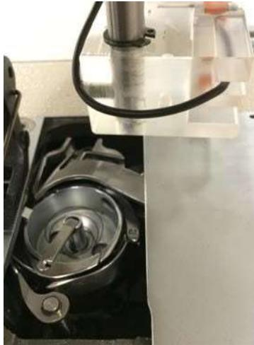
*Fig. 27. Fixando e removendo a bobina*
