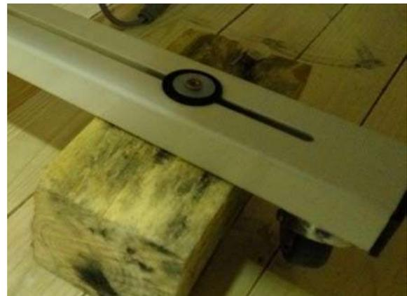
*Fig. 21. Suporte de pernas de fixação da máquina*
