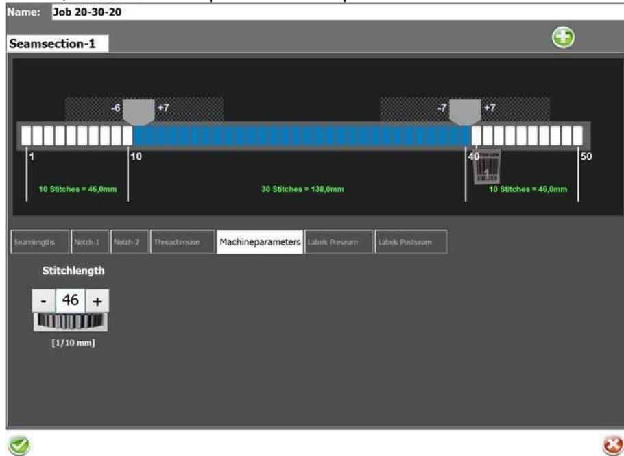
Fig. 54. Configuração de comprimento de ponto
