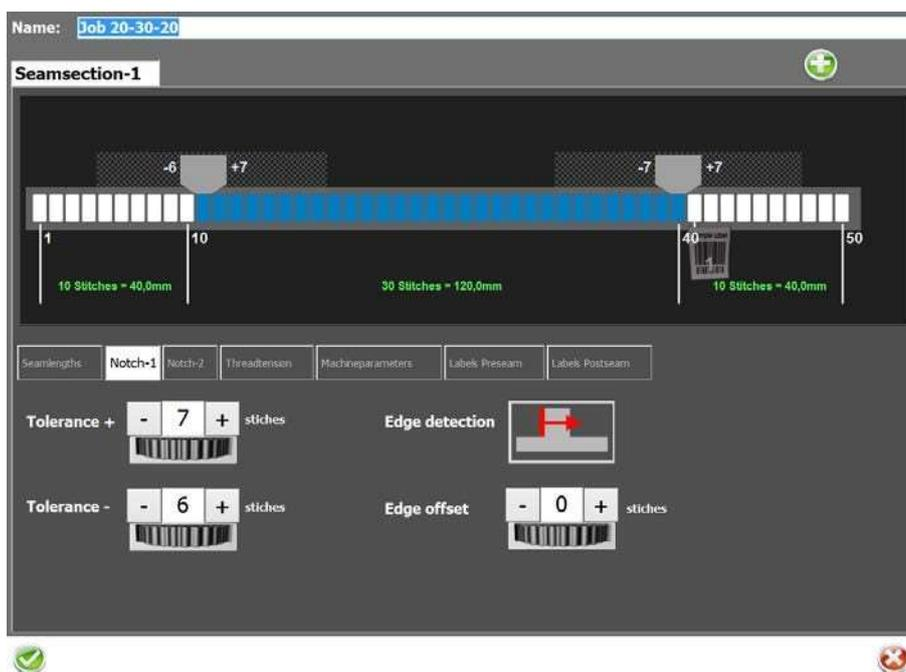
Fig. 51. Configuração de área cega e offset de borda (costura de segurança)
