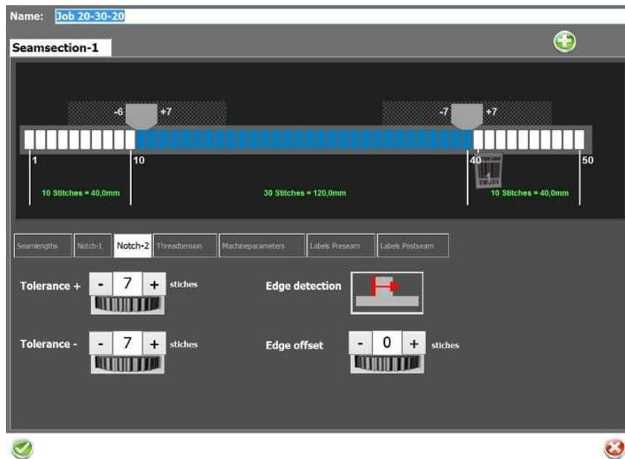
Fig. 52. Configuração de área cega e offset de borda (pós-costura)
