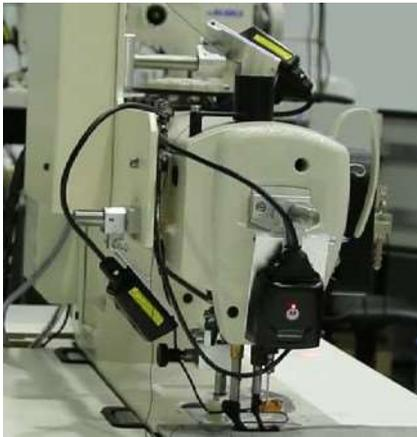
Scanner especial é montado na cabeça da máquina (figura 18). O propósito deste scanner é de verificar aplicação apropriada da rastreabilidade da etiqueta de código de barras para a peça, a então chamada scanner atrás.
